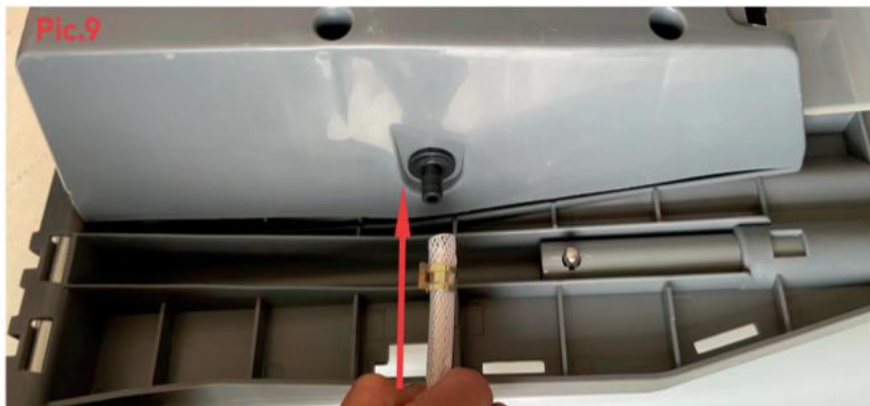
Conectati furtunul de aspiratie la corp si fixate-l cu o clema metalica
